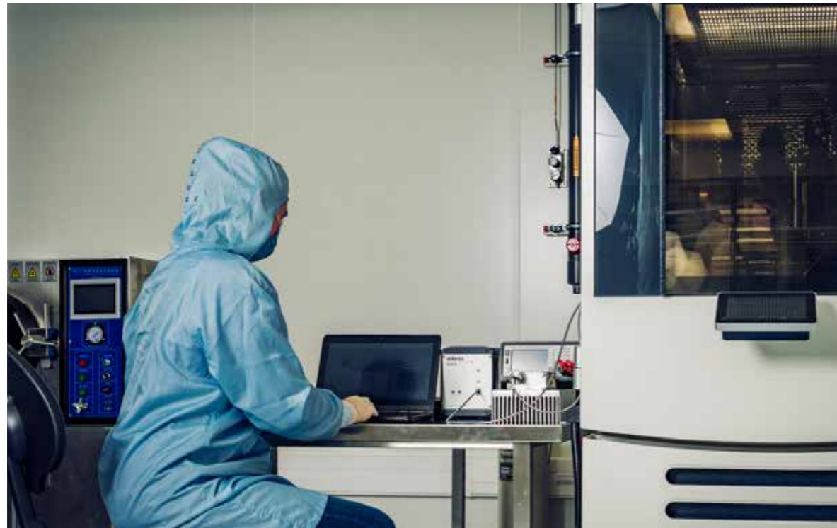
Enceinte climatique permettant de réaliser des tests de vieillissement accéléré. Elle permet de faire varier des paramètres tels que la température, l'humidité et la luminosité.
